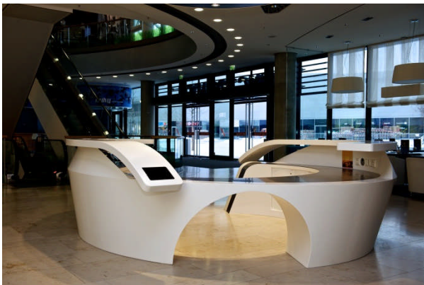
Bild: Hasenkopf-Pasing-Arcaden-Project-Luna-05.jpg BU: In die Theke wurden an den beiden Ablagen Tablet-PCs fugenlos integriert. Stabilität der „leichten Konstruktion“ wird durch eine innenliegende Stahlkonstruktion erreicht
